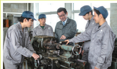
旋盤：加工物を回転する土台に取り付けて切削加工を学びます。
